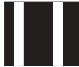
HDC-S4 Breite: 15 mm Abstand: 5 mm Bedruckungsgrad: 75 % M ca. 1:1
