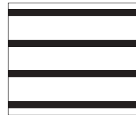
HDC-S5 Höhe: 2 mm Abstand: 7 mm Bedruckungsgrad: 22 % M ca. 1:1
