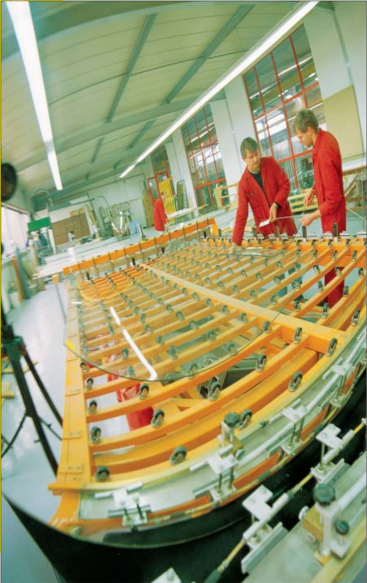
Fertigung gebogenes Glas
